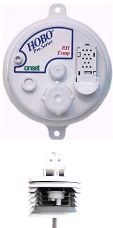
Hobo Pro dans l'abri météo 7714 (vue en coupe)
